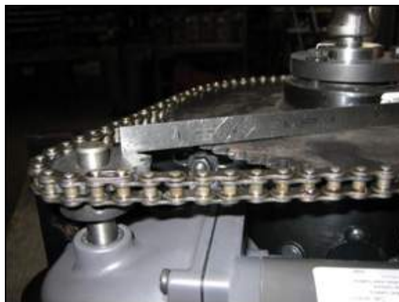
Рис. 17. Регулировка приводной цепи
